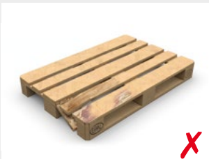
Bruch eines Querbrettes
