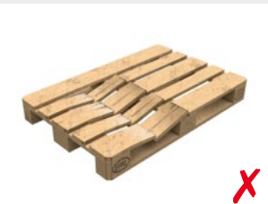
Schäden an mehr als 3 Bauteilen
