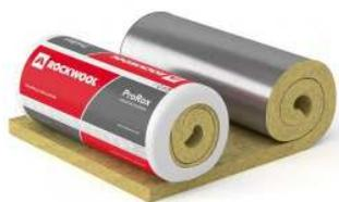
ProRox MA 520 ALU ist eine druckfeste, elastische Steinwolle-Matte höherer Rohdichte mit überwiegend senkrechter Faserstruktur, die einseitig mit reißfester gitternetzverstärkter Aluminiumfolie kaschiert ist.
