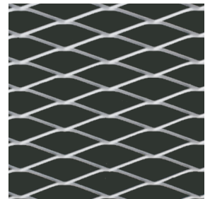
Mesh R60x20 70 % freier Querschnitt Strangbreite 3,0 mm Dicke 1,0 mm
