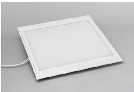
**Leuchtenkörper** Einbauleuchte, Einzelleuchte, Gehäuse weiß pulverbeschichtet. Vorgesehen für Einle-gemontage und verdeckte Systeme. Hocheffiziente LED-Lichteinheit. Lichtleitung über Opal-Kunstglasscheibe. Rahmen durch Riegelverschluss beidseitig abklappbar.
