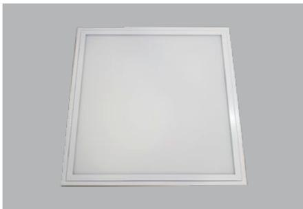
**Leuchtenkörper** Einbauleuchte, Einzelleuchte, Gehäuse weiß pulverbeschichtet. Vorgesehen für Einlegemontage und verdeckte Systeme. Hocheffiziente LED-Lichteinheit. Lichtleitung über satinierte Kunstglasscheibe. Rahmen durch Riegelverschluss beidseitig abklappbar.
