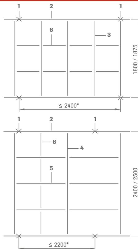
Bei zusätzlicher Auflage von Mineralwolleplatten sind die o. a. Spannweiten entsprechend zu verringern.
