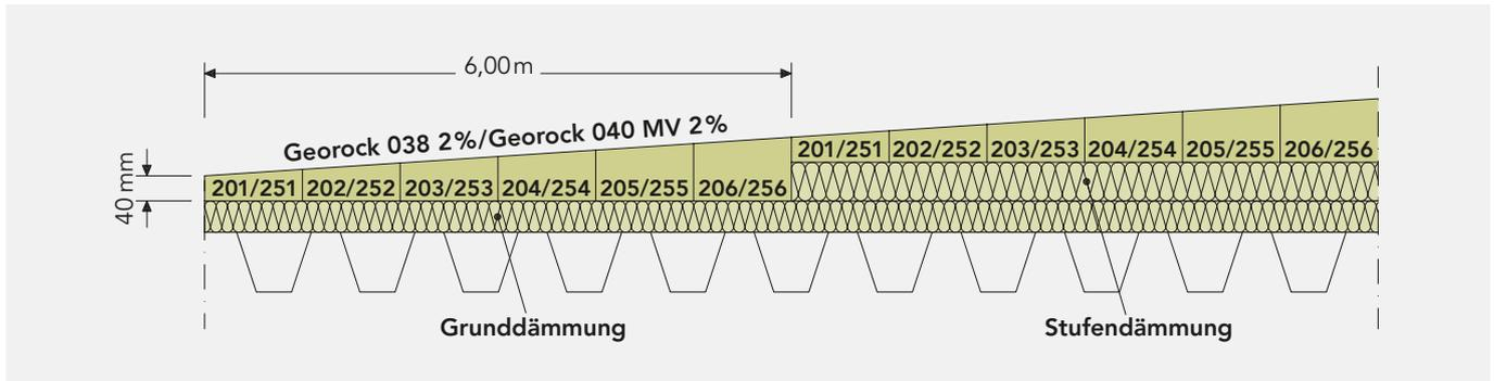
Die Gefälledachsysteme Georock 038 und Georock MV (Mineralvlieskaschierung) sind besonders gut geeignet für Neubau und Sanierung von Betondachkonstruktionen und Stahlleichtdächern zur Herstellung eines Gefälles von 2%.
