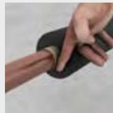
Schnell-Check: Fingerrückenprobe anwenden.
