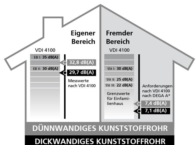
Prüf-Konfiguration bestehend aus einer komplett durchgedämmten Abwasserleitung DN 100. Mit Missel MSA-KLW, Düker Schall-Entkoppler (1) und Rohrschelle Walraven BIS Bifix G2 mit Einlage (M8/10) (BUP1000) (2). Gemessen bei einem Volumenstrom von 2 l/s. Messungen im eigenen und im fremden Bereich. Aufbau entspricht Einfamilienhaus/Mehrfamilienhaus.
