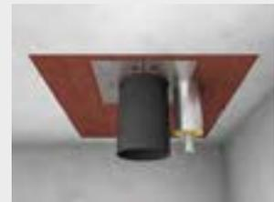
Rohrisolierungen aus Mineralwolle dürfen bis auf 10 mm an das brennbare Rohr herangeführt werden und das Streckgitter überdecken.
