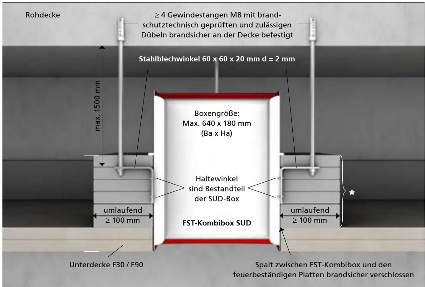
\* Feuerbeständige Platten (untereinander und mit Trockenbaudecke verklebt sowie zusätzlich brandsicher von oben mit Trockenbauschrauben (3,5 x 35 mm) verschraubt. Abstand max. 150 mm
