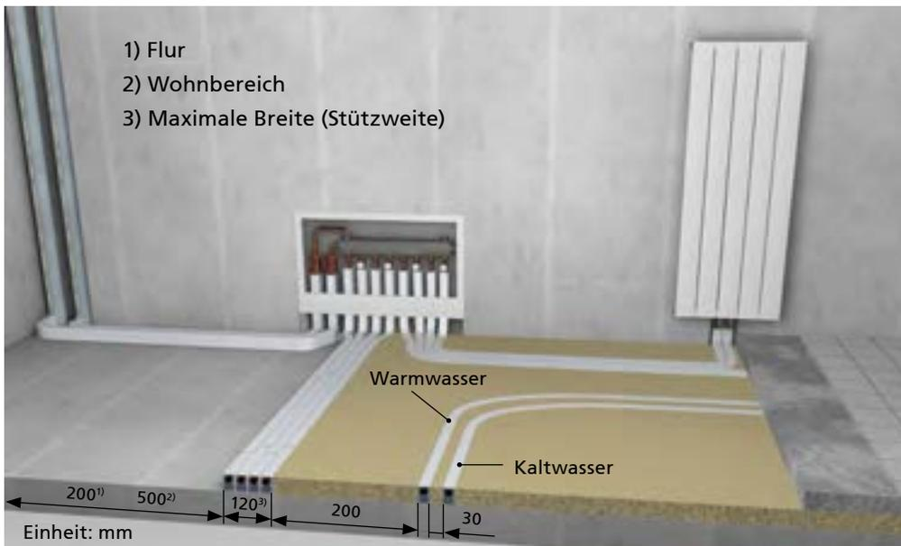
1. Die Rohrleitungen parallel zu den Wänden verlegen.
