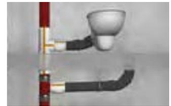
Bei Bedarf weitere Kunststoff-Rohranschlüsse unterhalb der Decke mit BSM-GuKu Manschette montieren.
