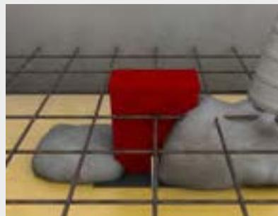
Befestigung direkt auf der Deckenschalung mit Einguss in den Ortbeton.
