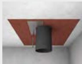
Das Streckgitter wird mit Allzweckschrauben (Grobgewinde)  $D \geq M6$ ,  $L \geq 150$  mm an den KaRo-Steinen verschraubt.
