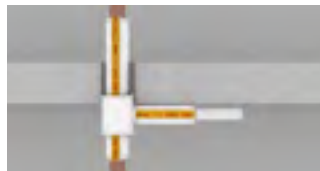
Seitlich brennbare Etagenleitungen
