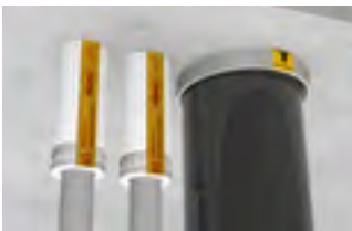
Abstand BSM-KR bis 110 mm zu BSM-R90/MSA 4-R90 (bis 64 mm Kupfer oder bis 114,3 mm Stahl/Guss oder bis 50 mm Mehrschichtverbundrohr). Weitere Rohre und Dimensionen auf Anfrage.
