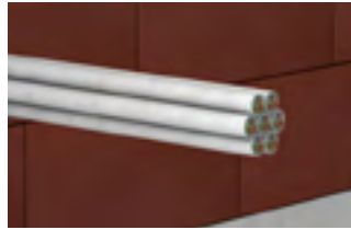
Fest verschnürte Kabelbündel bis zu einem Gesamtdurchmesser von 100 mm bestehend aus Mantelleitungen, Telekommunikationskabeln, optischen Faserkabeln mit einem maximalen Außendurchmesser der Einzelkabel von 21 mm (ein Verschluss der Kabelzwicke im Inneren ist nicht erforderlich).
