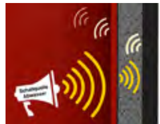
Schallreflexion an Schwererschicht der Dämmung
