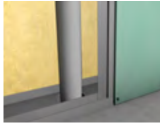
Abwasserleitung in der Vorwand
