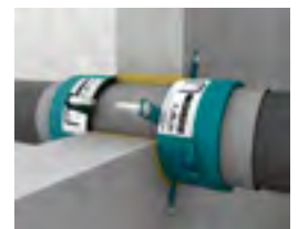
Bei einer Fugenbreite von ≤ 15 mm dürfen die Fugen mit Mineralwolle (Schmelzpunkt ≥ 1.000° C) fest ausgestopft werden.
