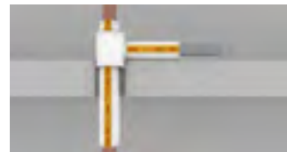
Seitlich nicht brennbare Etagenleitungen
