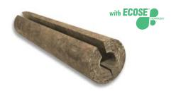
Die Rohrschalen Thermo-teK PS ECO sind gewickelte Steinwolle-Rohrschalen (vorgefertigte Rohrschalen DN bis 300 mm), die aufgrund modernster Fertigungstechnologien nur minimale Produkttoleranzen im Innen- und Außendurchmesser aufweisen. Die 1.200 mm lange Rohrschale ist zur besseren Montage einseitig
