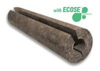
Power-teK PS 680 ist eine 1200mm lange gewickelte und geschliffene Mineralwolle-Rohrschale mit einseitiger Längsschlitzung (Gegenseite innen angeschlitzt) zur einfachen Endmontage am Rohr. Das Produkt ist nicht
