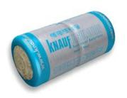
Power-teK LW STD ist lose Mineralwolle ohne Bindemittel, nichtbrennbar, schall- und wärmedämmend, alterungsbeständig, wasserabweisend. Für jede Art von Stopfdämmung, z.B. in schwer zugänglichen Hohlräumen im Anlagen- und Industriebau geeignet sowie für den Hochtemperaturbereich bis ca. 800 °C (abhänging von der Stopfdichte).
