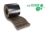
Die Thermo-teK LM Eco ALU ist eine Mineralwolle-Lamellenmatte aus einseitig auf reißfeste, glasgitterverstärkte Aluminium-Folie geklebten Mineralwolle-Streifen, die senkrecht zur Auflagefläche stehen. Dadurch ergibt sich eine gute Druckfestigkeit bei gleichzeitig angemessener Flexibilität für gute Verarbeitbarkeit. Die Thermo-teK LM Eco ALU ist nicht brennbar.
