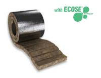
Power-teK LM 550 ALU ist eine Mineralwolle-Lamellenmatte aus einseitig auf reißfeste, glasgitterverstärkte Aluminium-Folie geklebten Mineralwolle-Streifen (Lamellen) und wird für den stützkonstruktionsfreien Wärme-, Schall- und Brandschutz von betriebstechnischen Anlagen verwendet.
