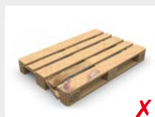
Bruch eines Querbrettes
