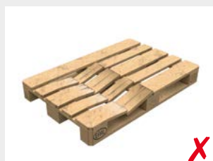
Schäden an mehr als 3 Bauteilen
