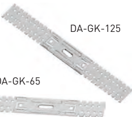
Direktabhänger, gestreckt für CD 60/27 Tragfähigkeitsklasse 0,40 kN (~40 kg)
