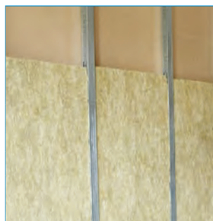
Termarock® 100 Feuerschutzplatte Euroklasse A1, Mindestrohdichte 100 kg/m 3 , Wärmeleitfähigkeit \lambda = 0,035 W/(m·K)
