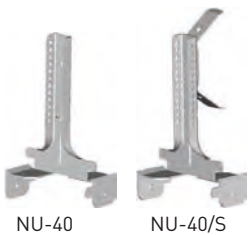
Noniusabhänger / Noniusabhänger mit Spannfeder für CD 60/27, Tragfähigkeitsklasse 0,40 kN (~40 kg). Verschraubung möglich.
