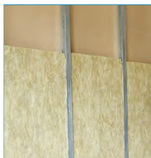
Termarock® 40 Feuerschutzplatte Euroklasse A1, Mindestrohdichte 40 kg/m 3 , Wärmeleitfähigkeit \lambda = 0,035 W/(m·K)
