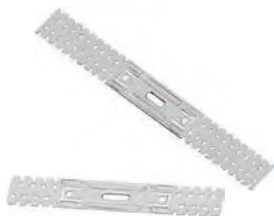
Direktabhänger, gestreckt – C3 für CD 60/27 Tragfähigkeitsklasse 0,40 kN (~40 kg)
