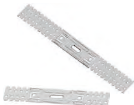
Direktabhänger, gestreckt – C5 für CD 60/27 Tragfähigkeitsklasse 0,40 kN (~40 kg)
