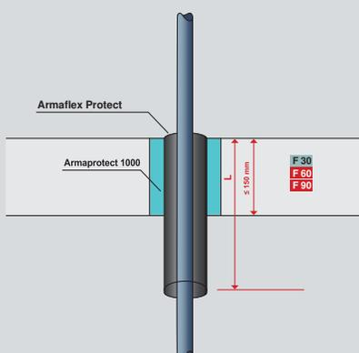
Montage bei Kunststoffrohren.
