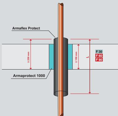
Wenn keine Isolierung über der Decke erforderlich oder möglich ist, kann ArmaFlex Protect auch unter der Decke installiert werden. Auf diesen Weg können beispielsweise Heizkörperanlagen einfach und sicher verschlossen werden.
