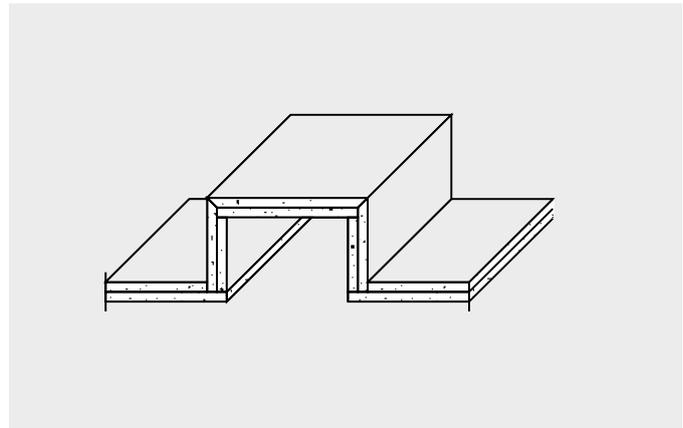
Sonderformteil Leuchtenkasten mit Brandschutzanforderung
